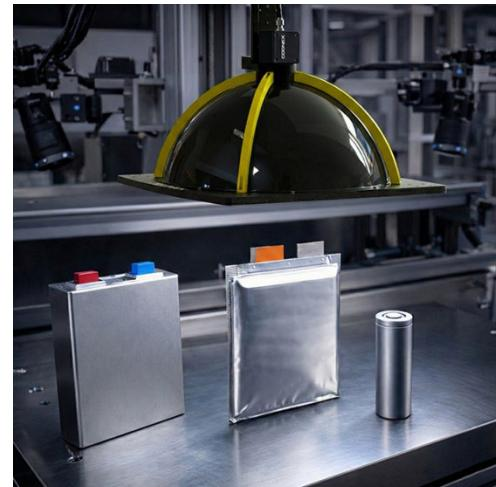
Dank der trevista® Technologie mit Shape-from-Shading-Verfahren ermöglicht das System eine hochpräzise topografische Analyse der Zelloberfläche, ohne störende Spiegelungen und unabhängig von Produktionsschwankungen. Dadurch lassen sich auch anspruchsvolle Defektarten wie Dellen, Kratzer, Mikrorisse, Bläschen oder Pin-Holes zuverlässig – selbst auf lackierten Batteriezellen – erkennen.
