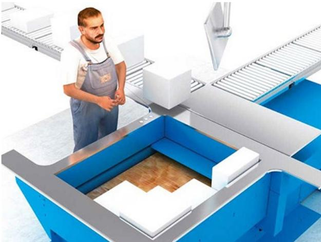
Bei der FAST PICK STATION handelt es sich um eine Einheit, die aus Kommissioniertisch, Schacht und Folienstretcher besteht. Sie ermöglicht es, Waren schnell, in hoher Qualität und ergonomisch auf Paletten zu kommissionieren.
