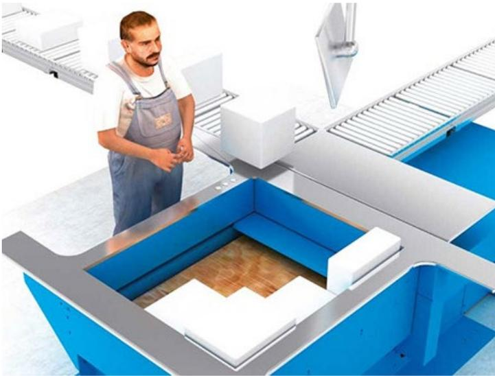
Bei der FAST PICK STATION handelt es sich um eine Einheit, die aus Kommissioniertisch, Schacht und Folienstretcher besteht. Sie ermöglicht es, Waren schnell, in hoher Qualität und ergonomisch auf Paletten zu kommissionieren.
