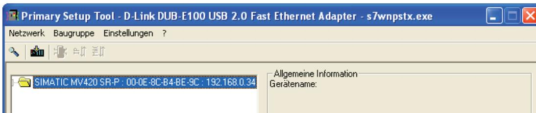
4. Durch einen Mausklick auf die angezeigte Ethernetschnittstelle werden die Eigenschaften der Schnittstelle angezeigt.
