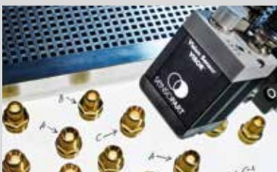
**Der mit dem „BLOB“:** Mit dem neuen BLOB-Detektor (Binary Large Object) erfasst der VISOR® auch kleine Unterschiede zwischen verschiedenen Objekten, zählt Teile oder erkennt, ob ein Teil auf dem Bauch oder Rücken liegt.
