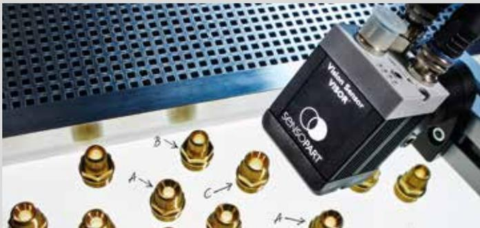
*Der mit dem „BLOB“:* Mit dem neuen BLOB-Detektor (Binary Large Object) erfasst der VISOR® auch kleine Unterschiede zwischen verschiedenen Objekten, zählt Teile oder erkennt, ob ein Teil auf dem Bauch oder Rücken liegt.
