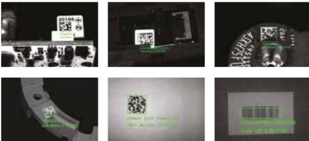
1DMax mit Hotbars II Technologie gewährleistet extrem schnelles Lesen von beschädigten oder schlecht gedruckten 1-D Barcodes bereits ab einer Größe von 0,8 Pixel pro Modul (PPM).
