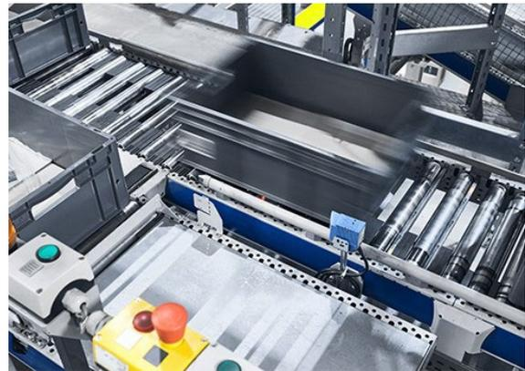
Zusätzlich kann die Behälterkontrolle über Barcode-Lesegeräte und entsprechende Behälter-IDs verknüpft werden, so dass IO- und NIO-Behälter nachverfolgt werden können.
